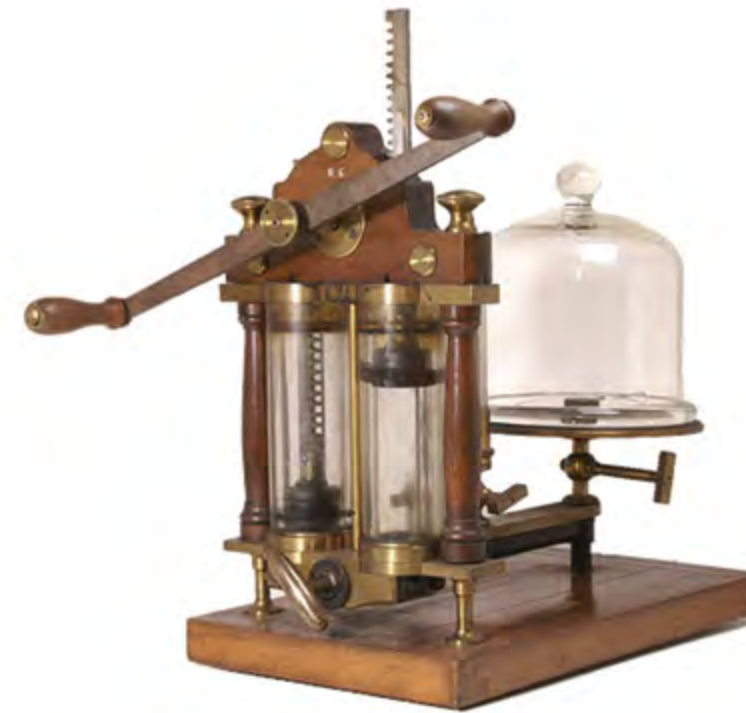
Figura 2.77: (a) Máquina neumática con dos cuerpos de bomba diseñada por el físico inglés Hawksbee. Imagen tomada de [30]. (b) Grabado de la Máquina tomado de [1], p. 184.
