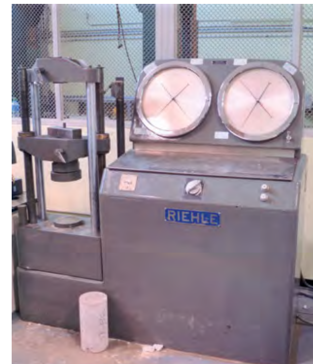
Figura 4.53: Máquina Universal hidráulica RIEHLE del laboratorio de ensaye de materiales (1957).
