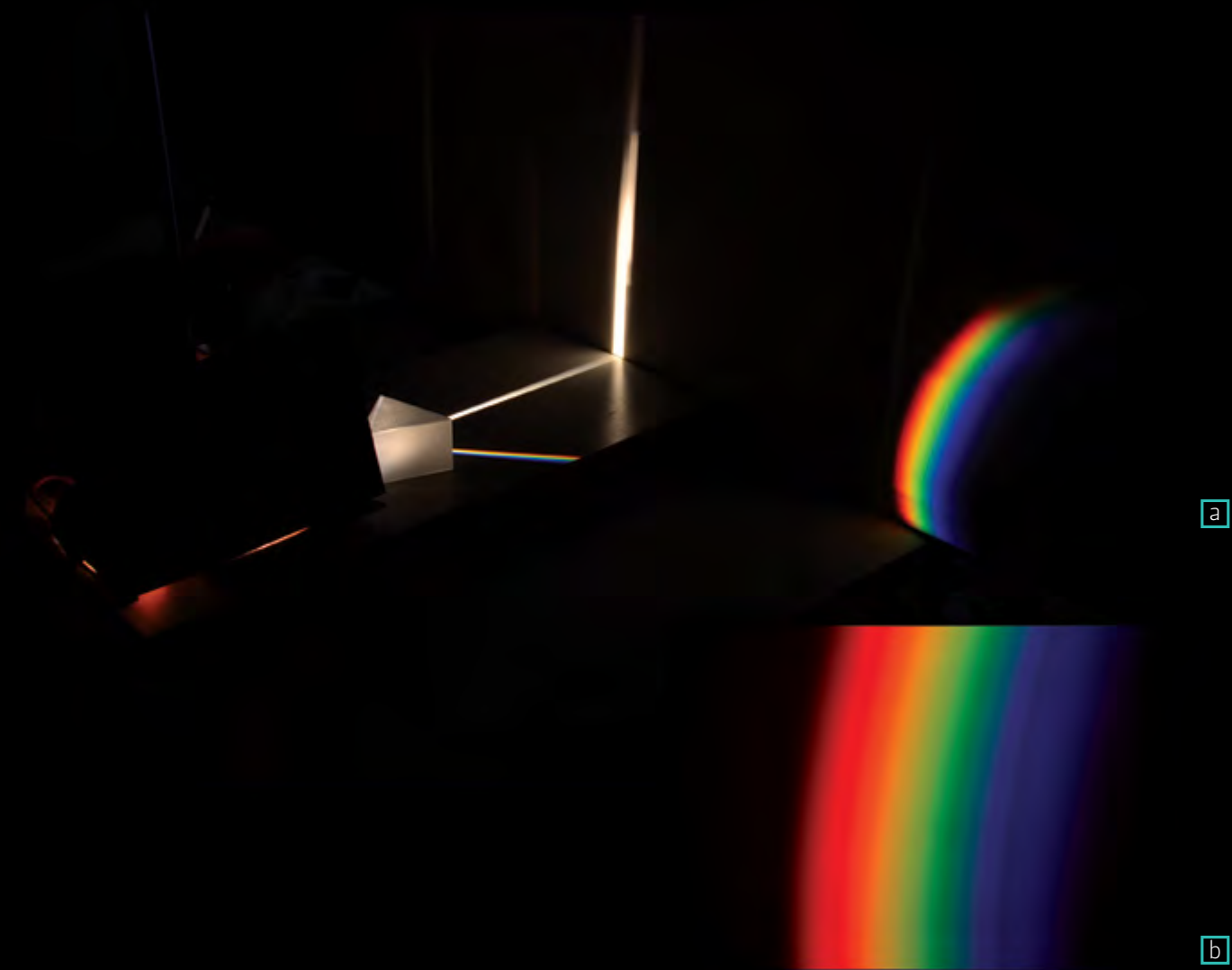
Figura 2.48: (a) Espectro debido a la descomposición de la luz blanca obtenido con un prisma. (b) Amplificación del espectro.
