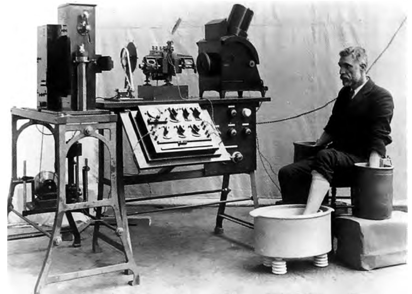
Figura 2.109: Electrocardiógrafo. Tenués pulsos de corriente eléctrica en el corazón pasan a través del cuerpo humano hasta la piel, pudiendo ser detectados por sensores metálicos y llevados a una gráfica llamada electrocardiograma. El primer electrocardiógrafo fue desarrollado por Willem Einthoven en 1900.
