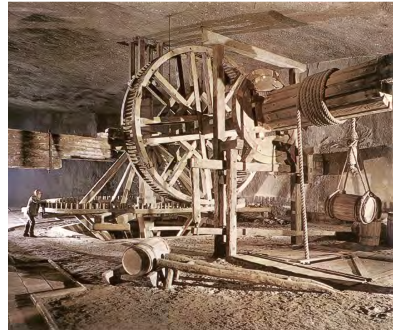
Figura 2.12: Las primitivas ruedas de engranajes, que a veces eran muy grandes, utilizaban clavijas de madera como dientes. Este conjunto de engranajes se halla en una mina de sal (en la actualidad un museo) de Wieliczka, Polonia y probablemente data del siglo XVIII. Fotografía obtenida del libro [9], p. 51.
