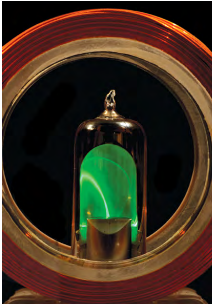
Figura 2.100: Amplificación del tubo mostrando la desviación del haz de electrones debida a la acción del campo magnético.
