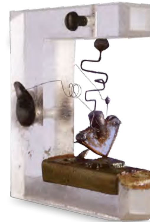
Figura 2.103: Transistor de 1947. Fotografía tomada de [19], p. 287.
