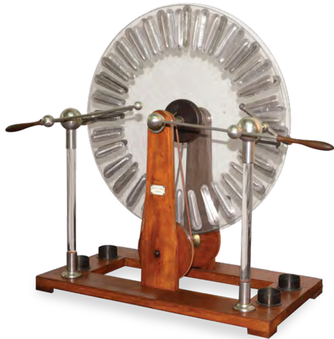
Figura 7.56: Máquina electrostática de influencia de Wimshurst. Se puede observar que faltan los capacitores.
