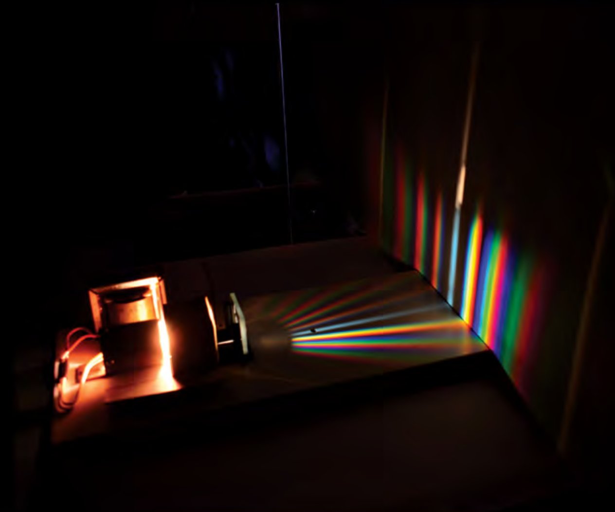
Figura 2.49: Espectro debido a la descomposición de la luz blanca obtenido con una rejilla de difracción.
