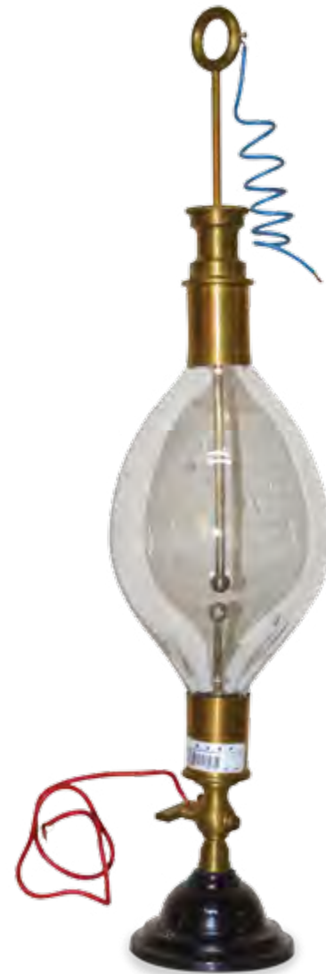
Figura 7.68: Ampolla eléctrica. El estudio de las descargas eléctricas en el vacío se efectúa por medio de este aparato.
