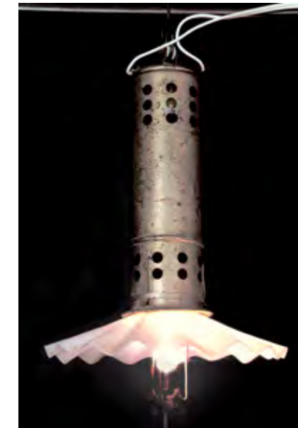
Figura 4.18: Lámpara de arco con regulador. Este tipo de lámparas fueron muy empleadas durante la última parte del siglo XIX. Colección particular.
