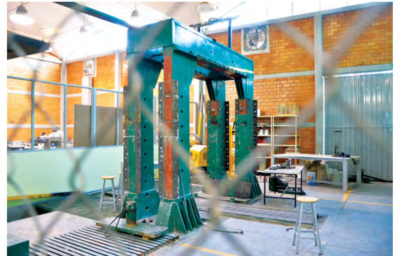
Figura 6.6: Laboratorio de ensaye de materiales de Ingeniería Civil. Marco de carga.
