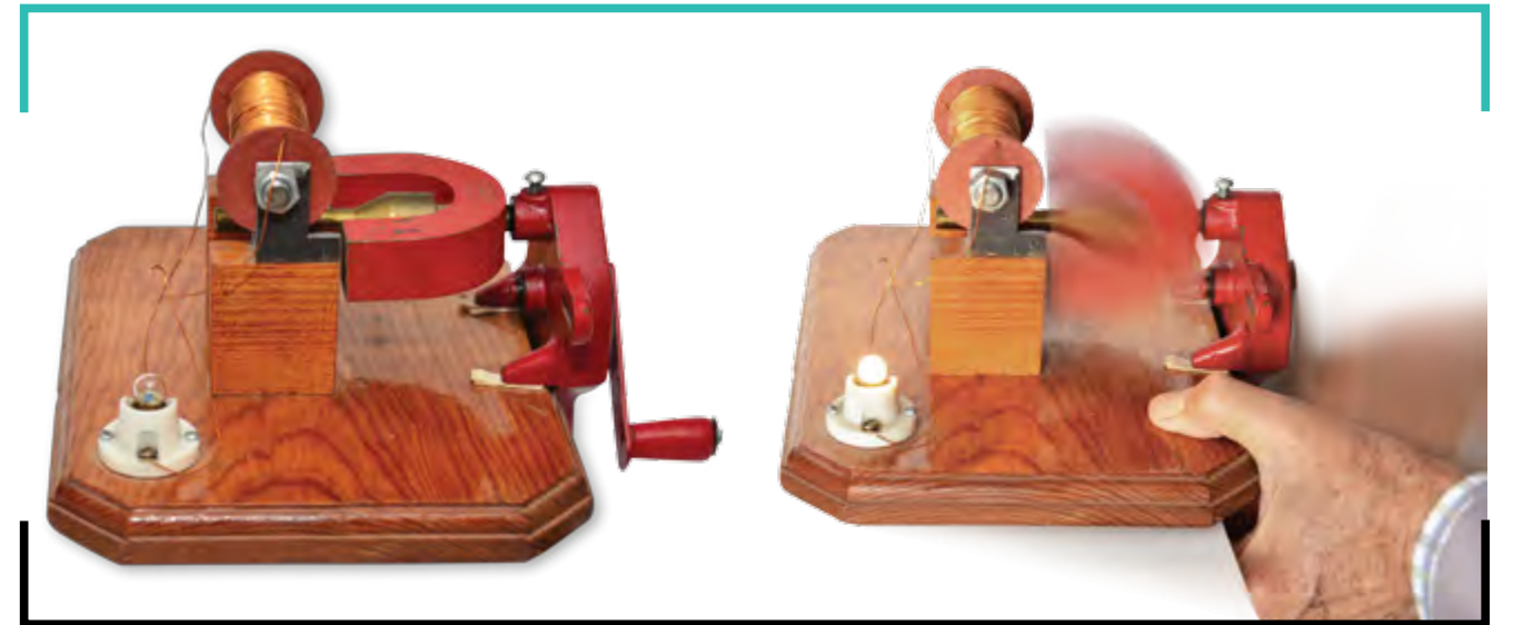
Figura 2.68: Fotografía de un generador sencillo tipo Pixii, construido por los autores.
