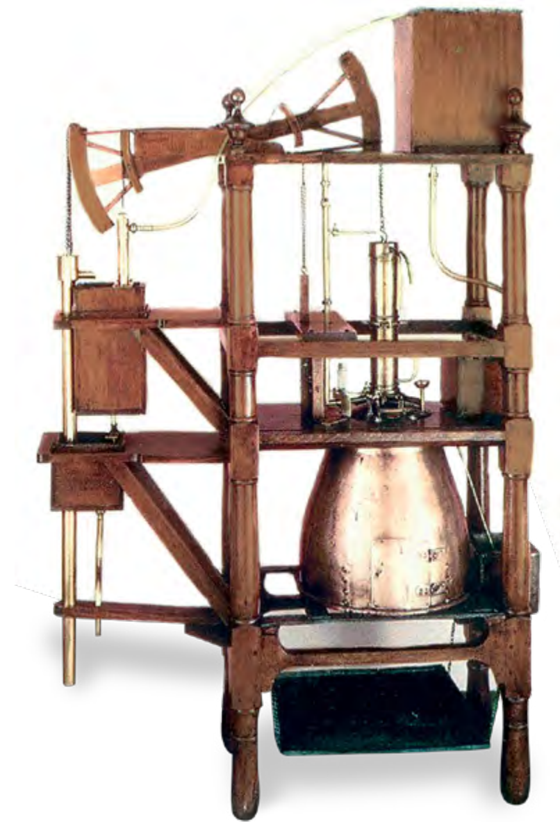
Figura 2.17: Modelo de demostración de la máquina de Newcomen del siglo XVIII. The Science Museum, Londres, Inglaterra.
