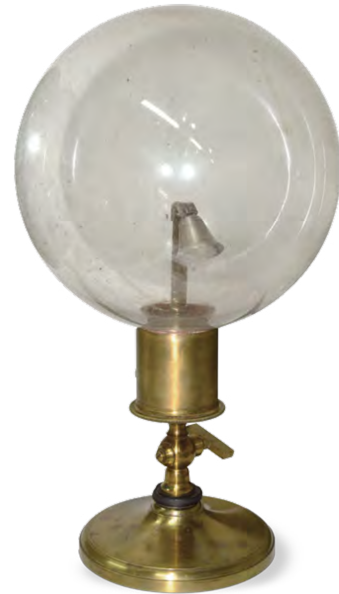
Figura 7.28: Campana en cápsula de vacío. Este aparato sirve para la demostración de la no transmisibilidad del sonido en el vacío.
