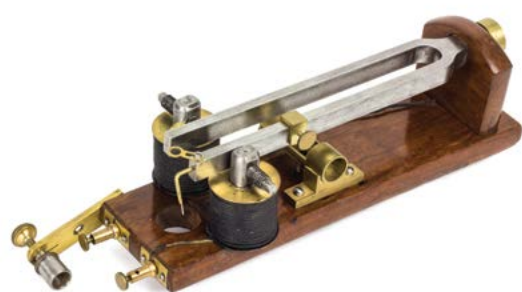
Fig. 33 Diapasón electroacústico. / Herramienta acústica, de factura industrial, hecha de acero, latón y madera. / Dimensiones: ancho 13 cm., largo 10 cm., alto 33 cm. / [Museo Universitario/BUAP].
